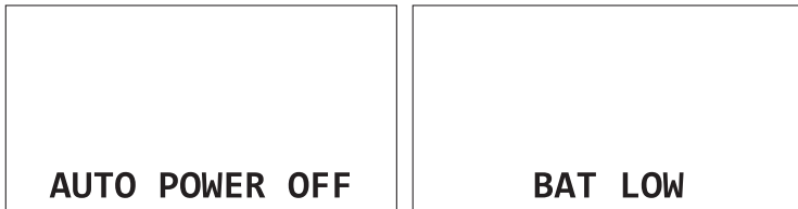
Abb. 5: Automatische Abschaltung Magnetometer wurde zwanzig Minuten nicht bedient (links) Restkapazität der Akkus ist zu gering (rechts)
