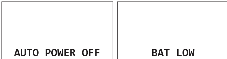
Abb. 4: Automatische Abschaltung: Teststab wurde zwanzig Minuten nicht bedient (links) Restkapazität der Akkus ist zu niedrig (rechts)
