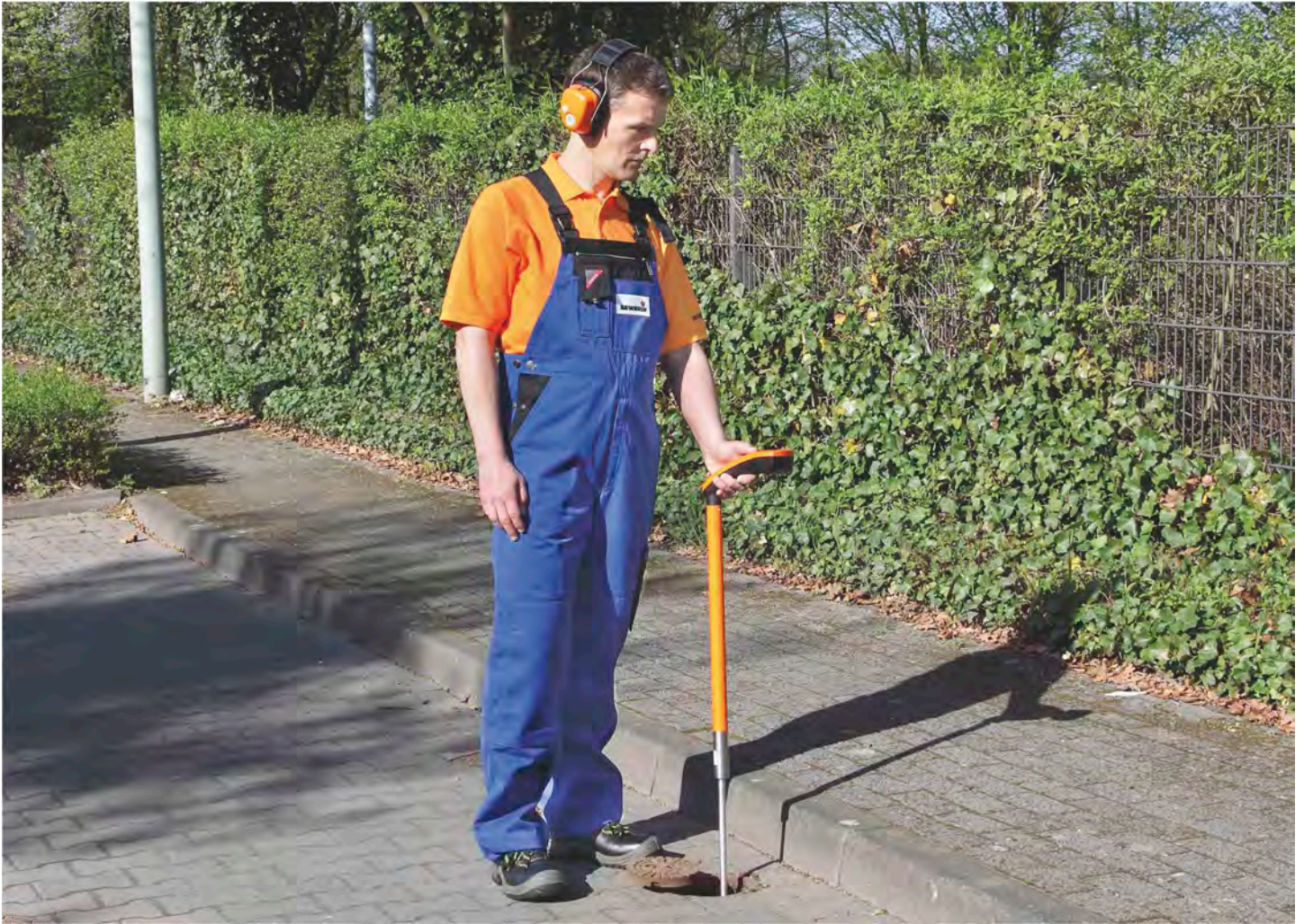
Bild 2: Verwendung eines Teststabs zur Vorortung
