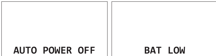
Fig. 4: Coupure automatique : la canne de test n'a pas été utilisée pendant vingt minutes (à gauche) la capacité restante des batteries est insuffisante (à droite)
