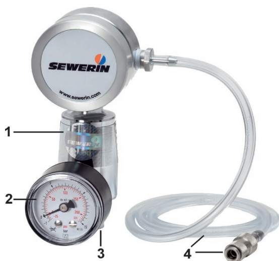
Fig.: Prüfeinrichtung SPE AutoFlow 1 Druckregler 2 Manometer mit Druckanzeige der Prüfgasdose 3 Anschluss Prüfgasdose 4 Prüfgasschlauch mit Geräteanschluss
