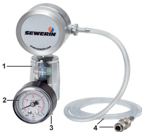
Fig.: Urządzenie do testowania SPE AutoFlow 1 Regulator ciśnienia 2 Manometr wskazujący ciśnienie w puszcze z gazem testowym 3 Złącze puszki z gazem testowym 4 Przewód do gazu testowego z przyłączem urządzenia
