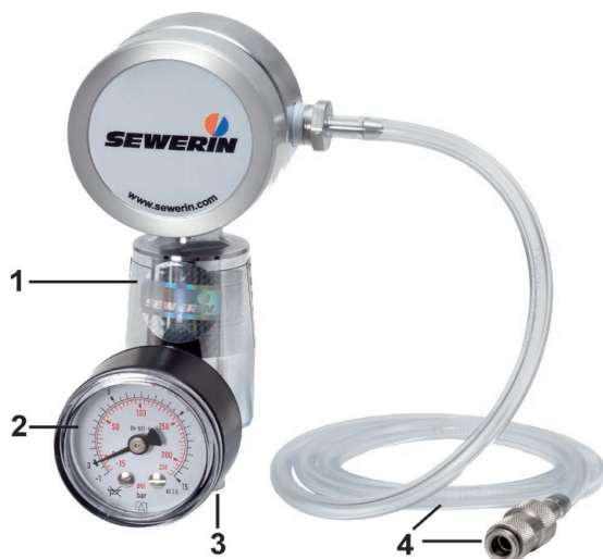
Fig.: Dispositivo di controllo SPE AutoFlow 1 regolatore di pressione 2 manometro con indicatore della pressione della bomboletta gas di prova 3 attacco bomboletta gas di prova 4 tubo flessibile gas di prova con raccordo di collegamento
