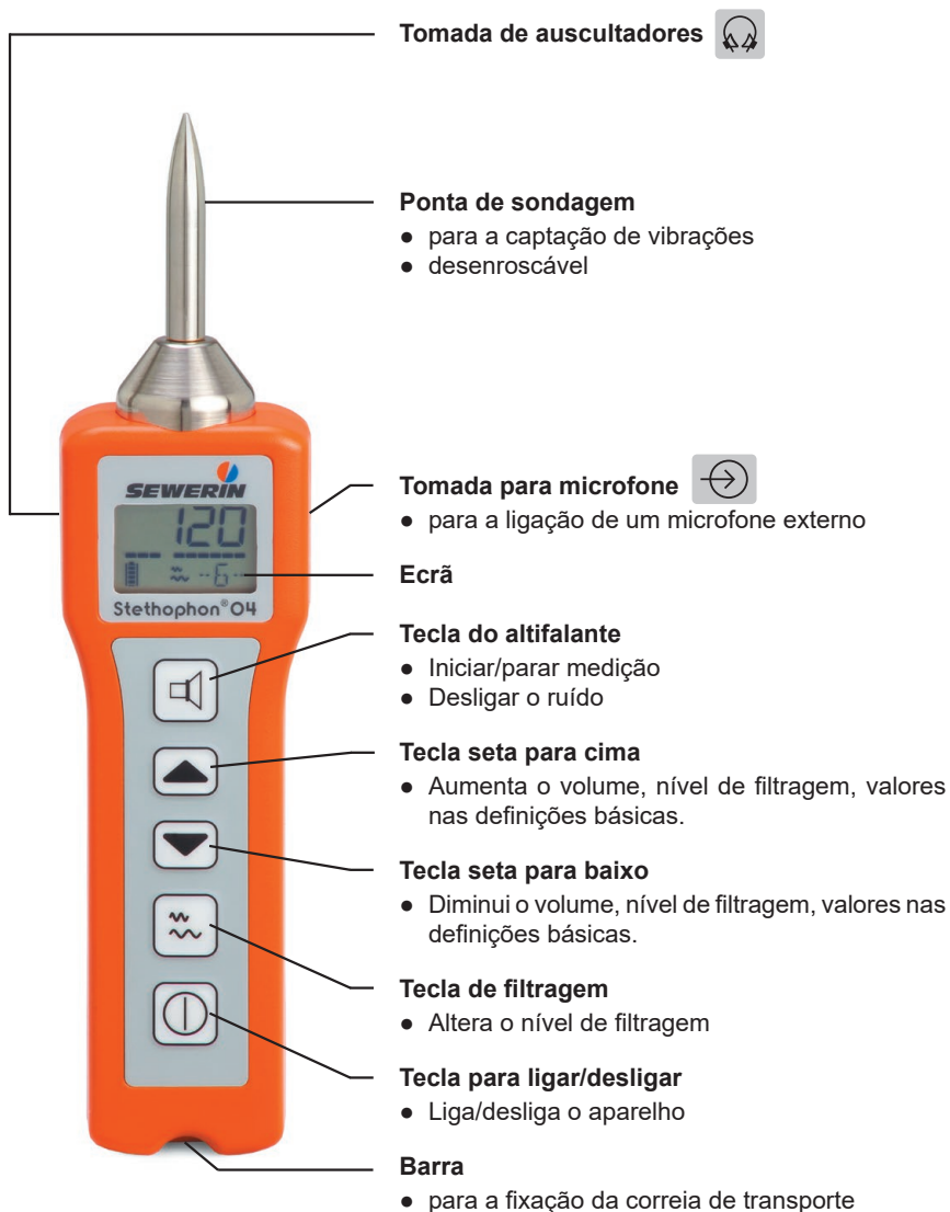
Figura Stethophon 04 – Estrutura do aparelho
