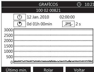
Fig. 10: Gráfico com pouca probabilidade de fuga
