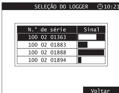
Fig. 12: Seleção do Logger para Logger único
