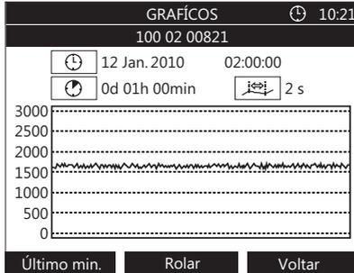
Fig. 9: Gráfico com elevada probabilidade de fuga
