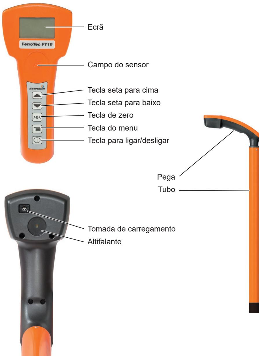
Fig. 1: **FerroTec FT 10** – pega na vista de cima (lado superior esquerdo), pega na vista de baixo (lado inferior esquerdo), vista lateral (do lado direito)
