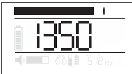
Fig. 6: Representação gráfica e numérica da intensidade do campo durante a localização de cabos
