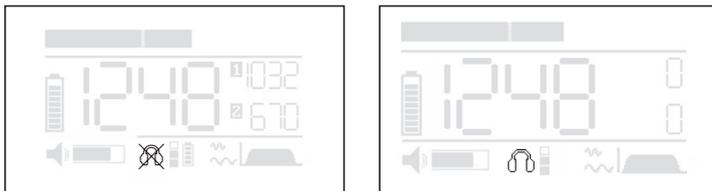
Fig. 11: Símbolo dos auscultadores com o sistema pronto a funcionar.
