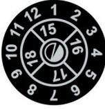
A placa de verificação presente no equipamento confirma a última revisão e identifica a data da próxima.
