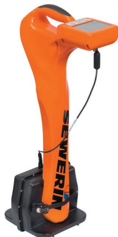
Fig. 35: Antenne pour boules marqueurs avec récepteur
