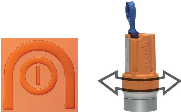
Fig. 3: Activation du logger : Déclenchement du commutateur d'activation du boîtier (à gauche). Sens de déplacement de l'aimant (à droite)
