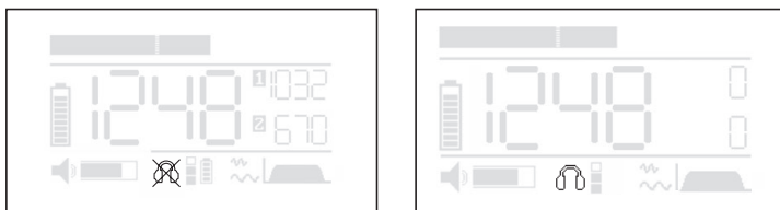
Fig. 11: Symbole de casque lorsque le système est prêt à fonctionner Image de gauche : Symbole barré, pas de mesure ou seuil de protection auditive dépassé pendant la mesure Image de droite : Symbole non barré, mesure en cours
