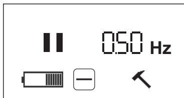
Fig. 13: La inducción de señal para la localización acústica – vista principal cuando se utiliza el mando a distancia (icono de pausa )
