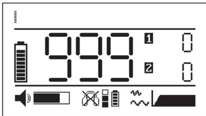
Fig. 6: Sistema con auriculares inalámbricos **F8** listo para el uso (se ve el símbolo de pila/batería de los auriculares inalámbricos)
