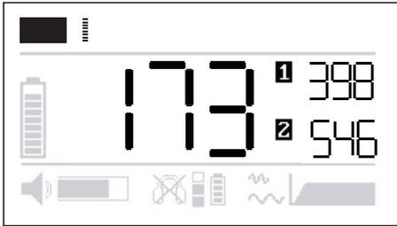
Fig. 4: Representación gráfica y numérica de los niveles de sonido en la función de nivel máximo
