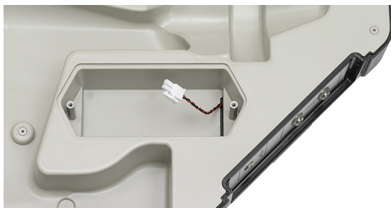
Fig. 25: Compartimiento de las pilas/baterías del G 100 con cable de conexión
