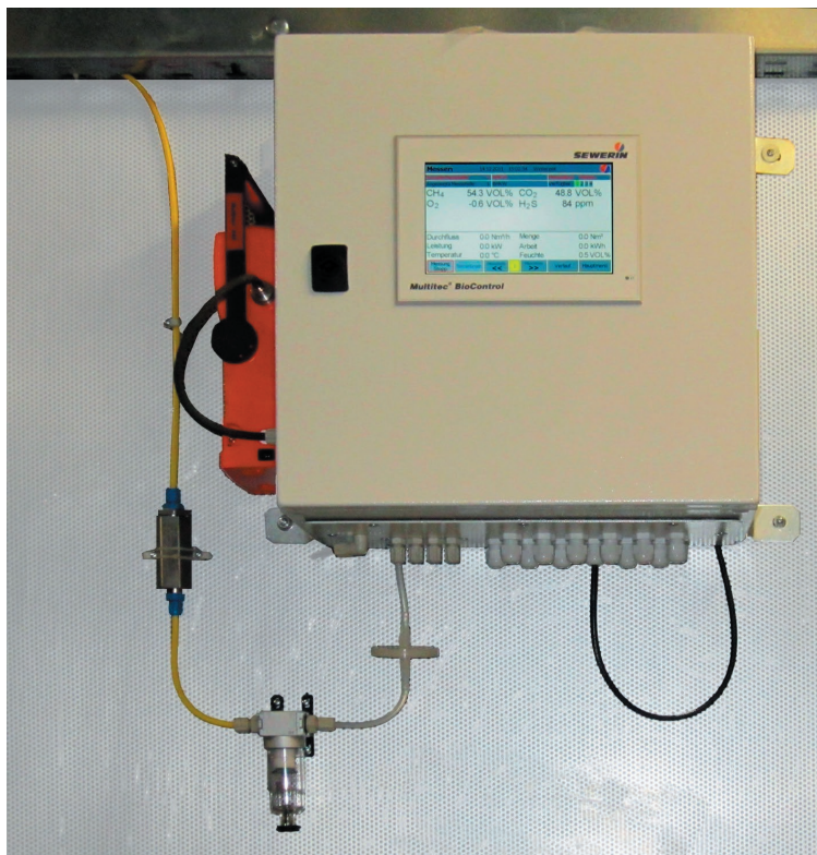
Fig. 4: Ejemplo de una instalación: BioControl 4 con un punto de medida conectado
