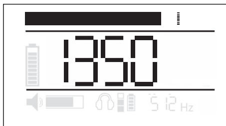
Fig. 6: Presentación gráfica y numérica de la intensidad de campo durante la localización de tuberías
