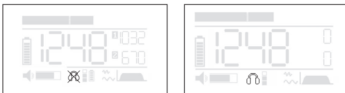
Fig. 11: Símbolo de auriculares en un sistema listo para el uso imagen izquierda: símbolo tachado, es decir, no se ha superado ninguna medición ni ningún umbral de protección para los oídos durante una medición imagen derecha: símbolo no tachado, es decir, hay una medición en curso.
