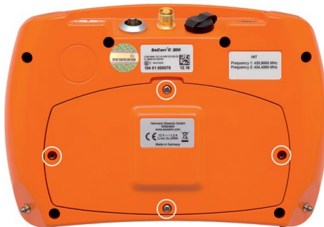
Abb. 43: Rückseite des Empfängers C 200 weiße Kreise: Schrauben des Batteriefachdeckels
