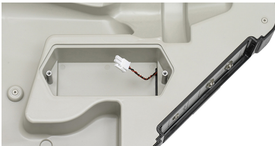
Abb. 25: Batteriefach des G 100 mit Anschlusskabel
