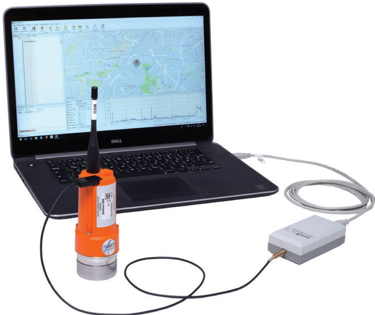
Abb. 4: Aufbau des Systems zur Programmierung des Loggers
