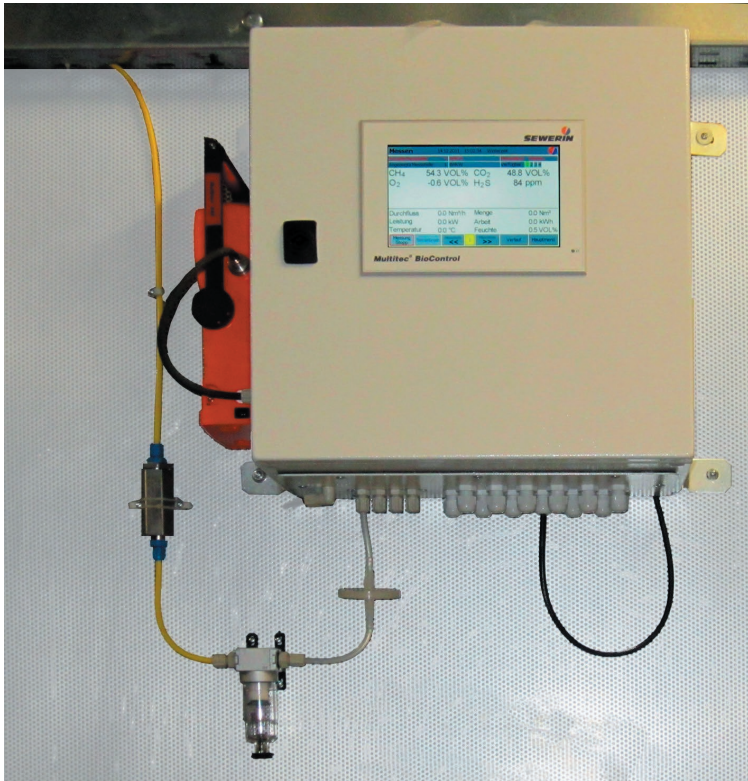
Abb. 4: Beispiel einer Installation – BioControl 4 mit einer angeschlossenen Messstelle
