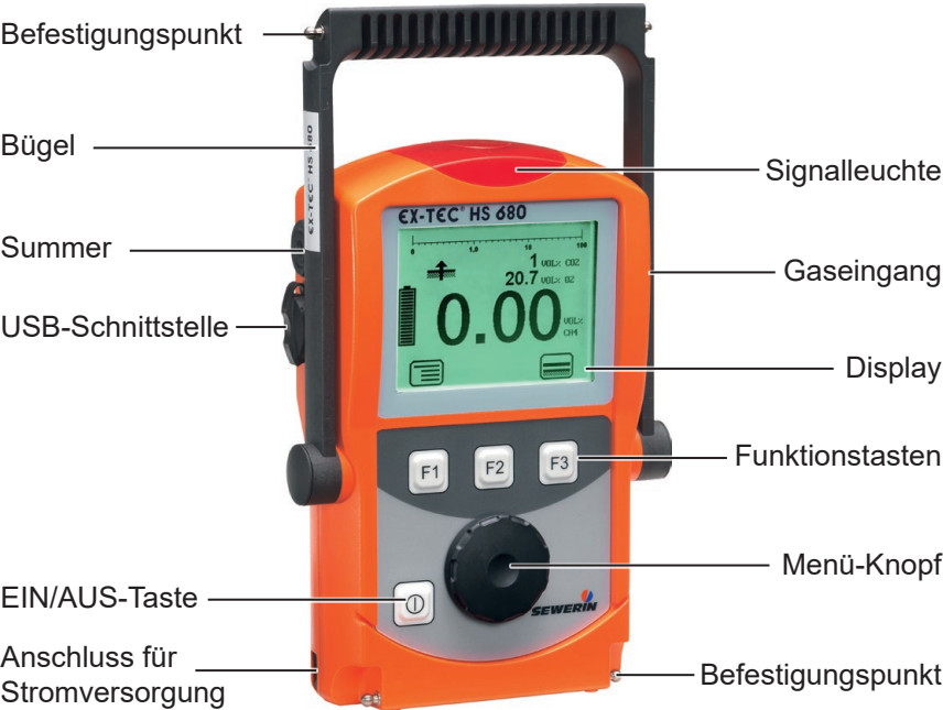
Abb. 1: Geräteübersicht EX-TEC HS 680
