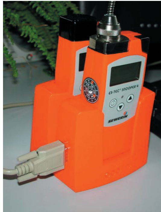
Abb. 16: Zwei kaskadierte Ladestationen mit Anschlusskabel zum PC
