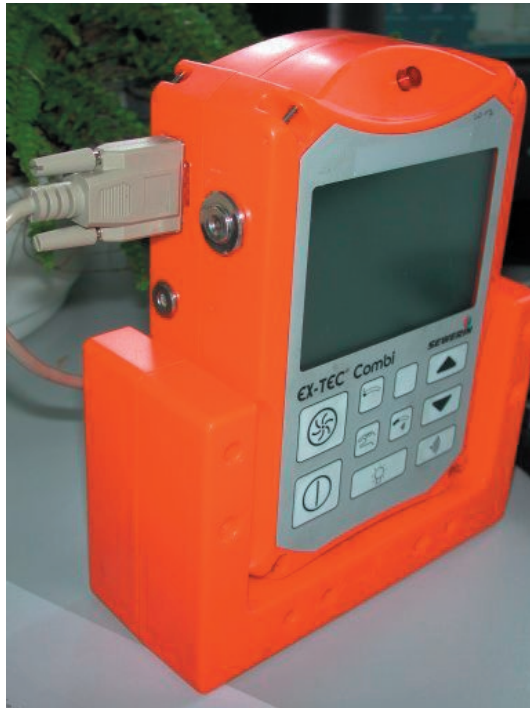
Abb. 13: EX-TEC Combi mit 9-poligen D-SUB-Kabel (Serie bis Ende 2002)
