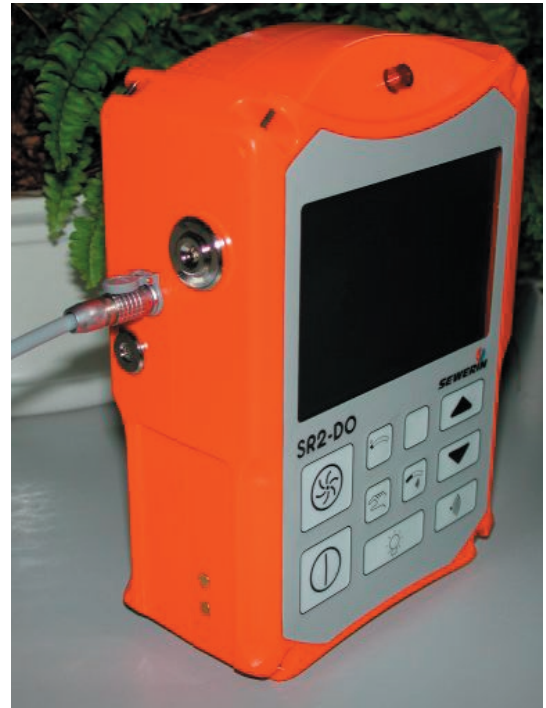
Abb. 14: SR 2-DO mit Kommunikationskabel (Serie ab 2003)
