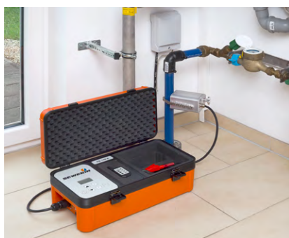
Localização de tubagens metálicas e tubos em plástico
