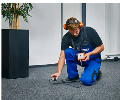
Localização de tubagens com o recetor AF 50 e um sensor bobine SK3
