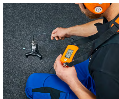
Localização de tubagens com o recetor AF 50 e o microfone universal UM 50
