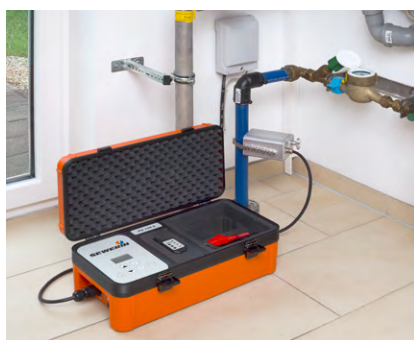
Localisation de conduites métalliques et plastiques
