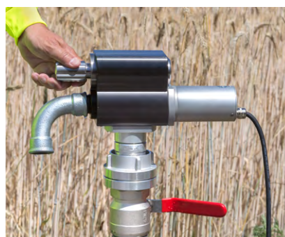
Localisation de conduites métalliques
