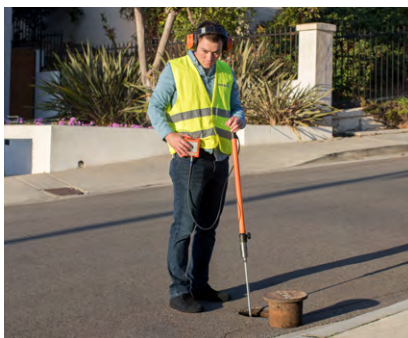
Prelocalización de fugas
