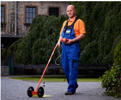
Oberirdischer Nachweis von Wasserstoff
