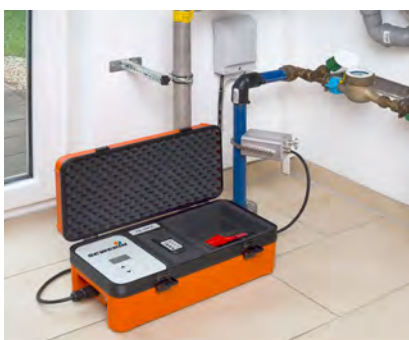
Ortung metallischer Leitungen und von Kunststoffleitungen
