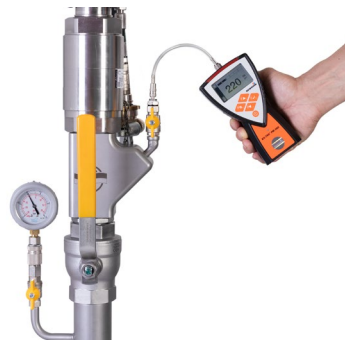
Einsatzfall Spülen Gasreinheit
