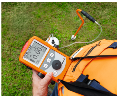
Anwendungsfall Prüfung Bodenluft
