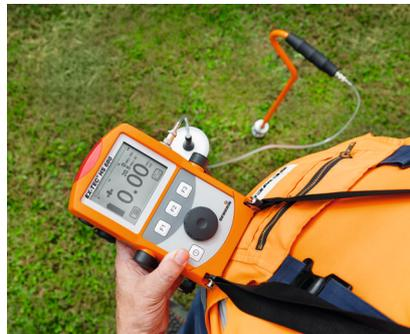
Anwendungsfall Prüfung Bodenluft
